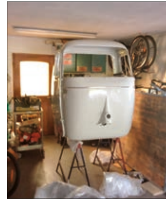
Nach etlichen Stunden Schweißarbeit war die Kabine frisch lackiert.
